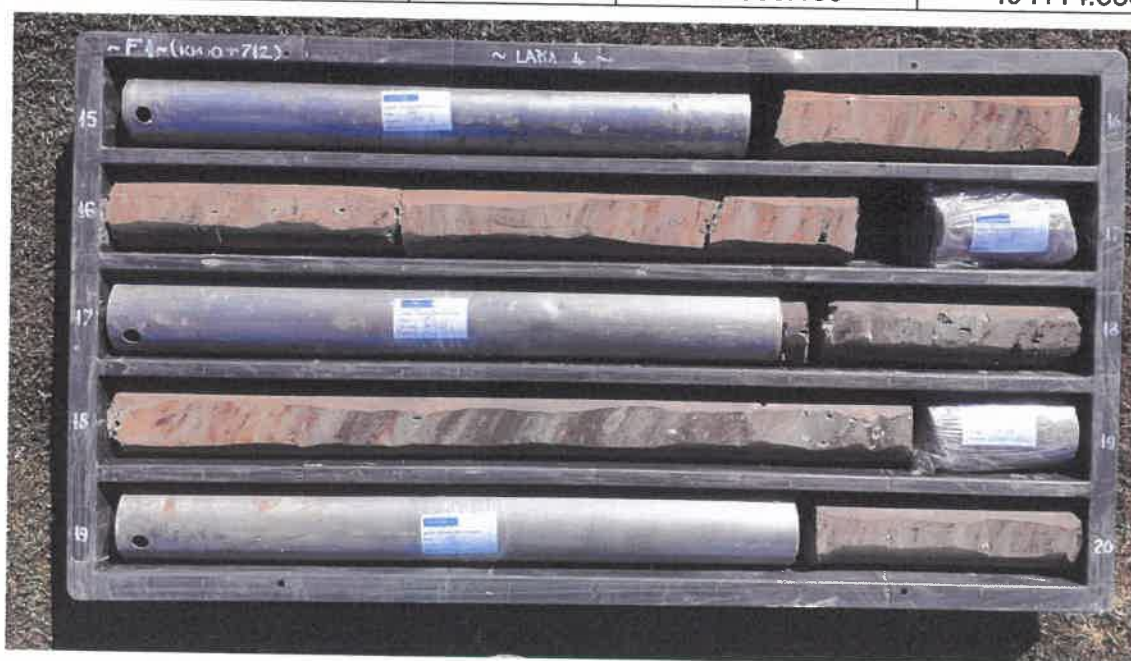
Figura 11. Exemplu de coloana litografică prelevată din forajele geotehnice
