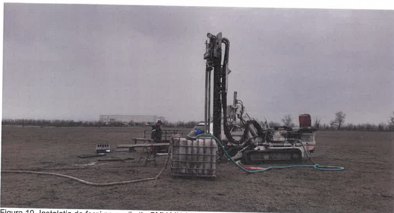
Figura 10. Instalatia de foraj pe senile tip CMV MK 600 M, utilizata pentru executia forajelor din amplasament
