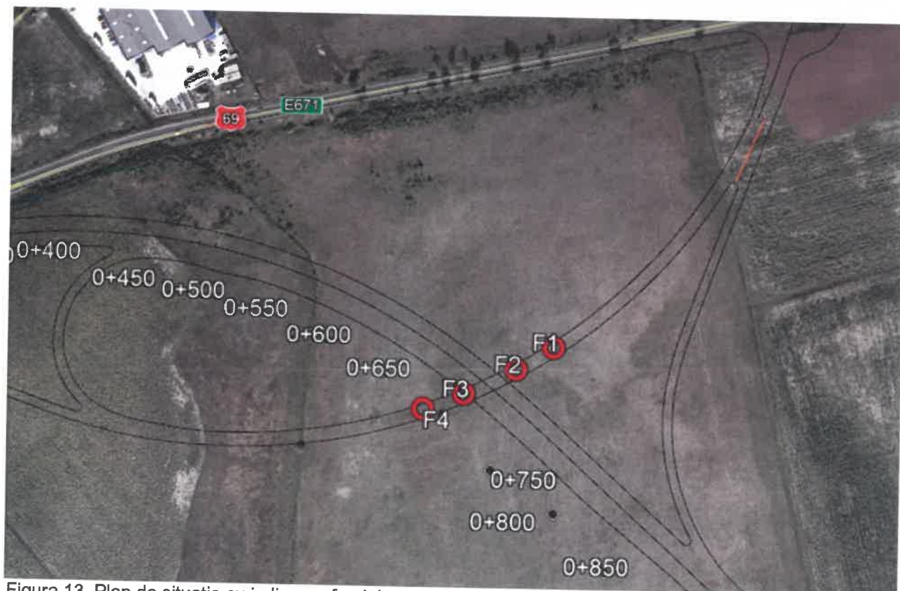
Figura 13. Plan de situatie cu indicarea forajelor geotehnice executate in amplasament (imagine preluată din Google Earth)
