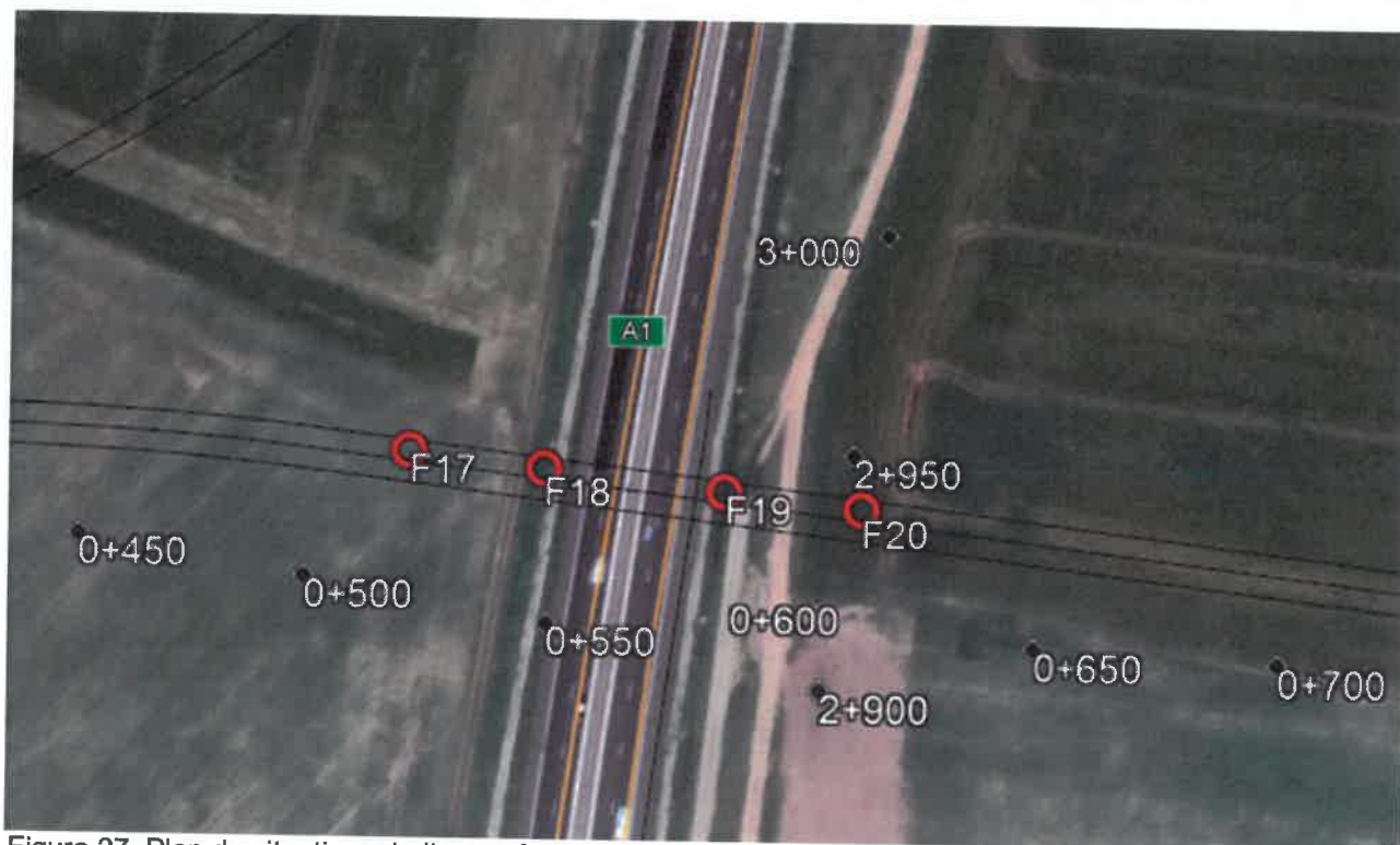
Figura 27. Plan de situatie cu indicarea forajelor geotehnice executate in amplasament (imagine preluată din Google Earth)
