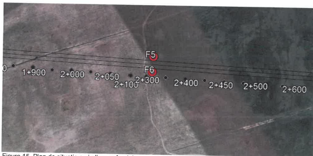
Figura 15. Plan de situatie cu indicarea forajelor geotehnice executate in amplasament (imagine preluată din Google Earth)
